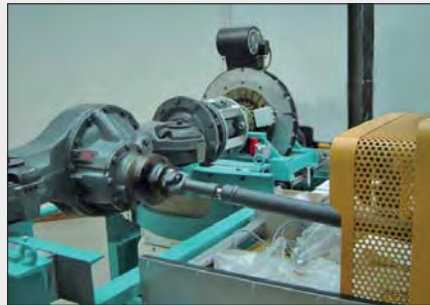
Prüfstand für LKW-Hinterachsen Test bench for truck axles
